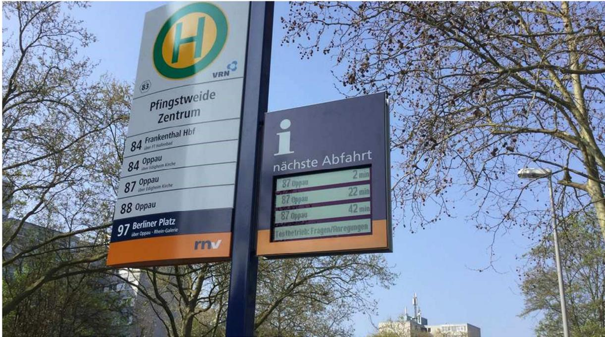
Abbildung 38: Beispiel eines batteriebetriebenen DFI-Displays aus Ludwigshafen
