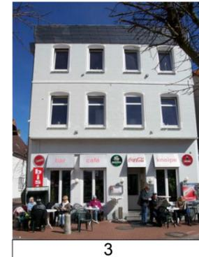
Die neuen, senkrecht proportionierten Fenster im EG harmonieren gut mit der historischen Fassade der oberen beiden Geschosse mit geschlammtem Mauerwerk und verzierten Fen-ster-einfassungen.
